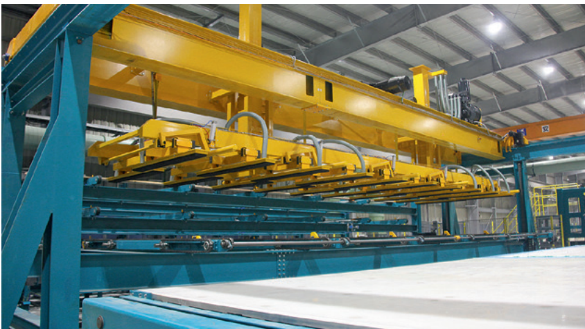
Doppelvakuum-Entstapelung zur Vorbereitung der Lagen vor der 12 m-Press
