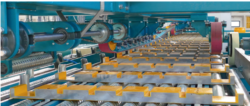
Die Kontizink schafft bis zu 120 Stück pro Minute und fährt mit 120 m/min
