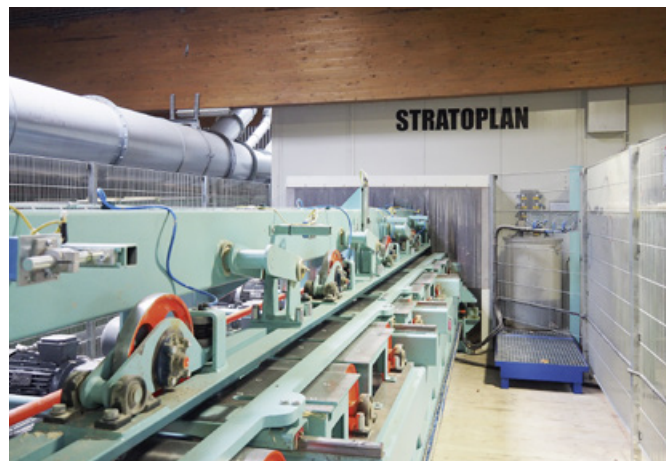
Ledinek musste die Stratoplan in die bestehende Halle einbauen – aufgrund der Hallenträger wurde die Zuführstrecke verlängert
